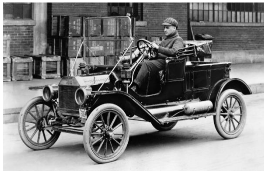
Ford Model T 1910 550 kg, 15 kW, 15 l/100km
