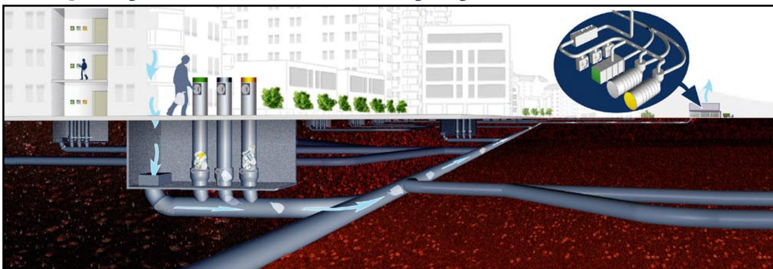
Un sistema computerizzato aziona delle ventole per l'aspirazione dei rifiuti (nelle condutture la velocità è intorno ai 70 km/h) che, viaggiando sulla medesima conduttura, ma mantenendosi separati grazie ad un pompaggio cronologicamente diversificato, raggiungono dei grandi container di stoccaggio posti in zone sufficientemente distanti dalle abitazioni.
